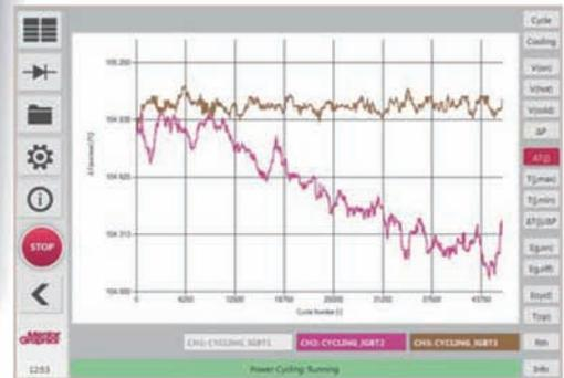
다양한 측정 시나리오를 사용한 사이클 테스트 중 DUT 정션온도의 변화 값을 표시한 예
