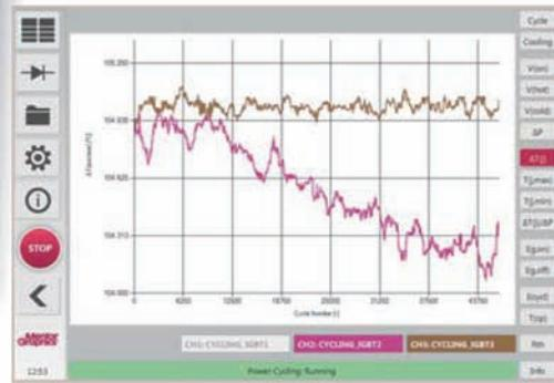
다양한 측정 시나리오를 사용한 사이클 테스팅 중 DUT 정션온도의 변화 값을 표시한 예
